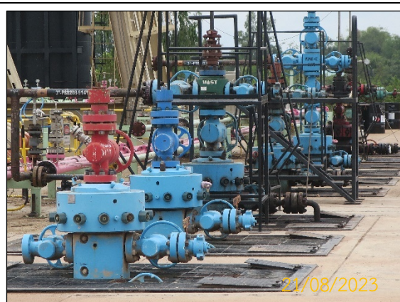
ภาพที่ 2.2-4 ระบบวาล์วบริเวณหัวบ่อ Christmas Tree และบริเวณ Choke Manifold
