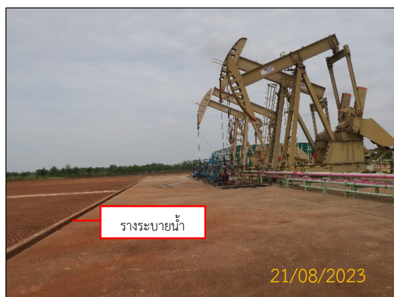
ภาพที่ 2.2-9 การจัดวางและติดตั้งอุปกรณ์การผลิต และสารเคมีบนพื้นคอนกรีตที่มีวางระบายน้ำล้อมรอบ
